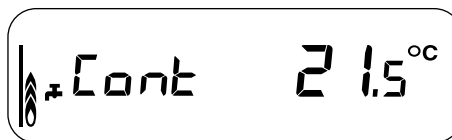
Figuur 23: Temperatuur continu, tapwater in bedrijf.
