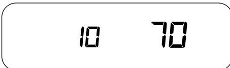
Figuur 26: Gevraagde watertemperatuur = 70 °C.
